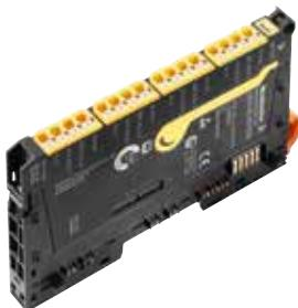
Büyük ölçekli makine uygulamaları fabrika personeli için tehdit oluşturmaktadır. Bu tehditlerin başında hareketli robot kolları ve hidrolik silindirler örnek olarak gösterilebilir. Bu koşullara karşı emniyet çözümleri kapsamında Weidmüller'in remote I/O ailesine safety power-feed modülleri eklenmiştir.
