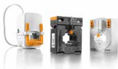
Weidmüller'in portföyüne dahil etmiş olduğu yeni akım trafoları ile 750A gibi tek veya üç fazlı sistemlerin kullandığı yüksek akım seviyelerini 1 veya 5A gibi düşük akım seviyelerine çevrilmesi sağlanmaktadır. Bu sayede akım izleme veya enerji analizörleri gibi komponentlerin sistemlere entegrasyonu mümkün kılınmaktadır. Weidmüller sunmakta olduğu geniş ürün portföyü ile bara tipi uygulamalara cevap vermekte birlikte kablo tipi akım trafoları ile mevcut sistemlere entegrasyonu mümkün kılınır.
